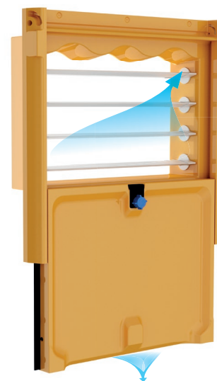
summer position – incl. floor ventilation (> 75 %)
