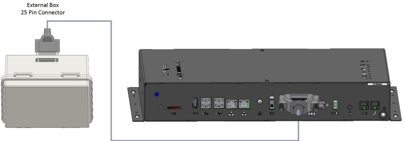
الشكل 4: العلبة الخارجية - كابل جهاز Communicator 2.0
