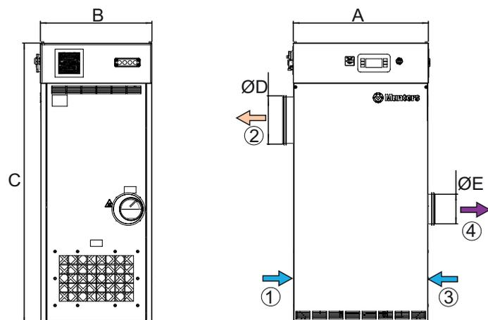
1. Aria di processo      2. Aria secca      3. Aria di rigenerazione      4. Aria umida
