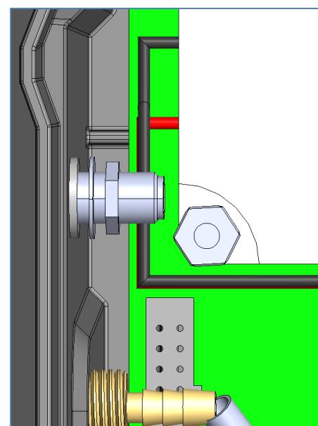
3. 将调制解调器电缆插入连接器，如下图所示。
