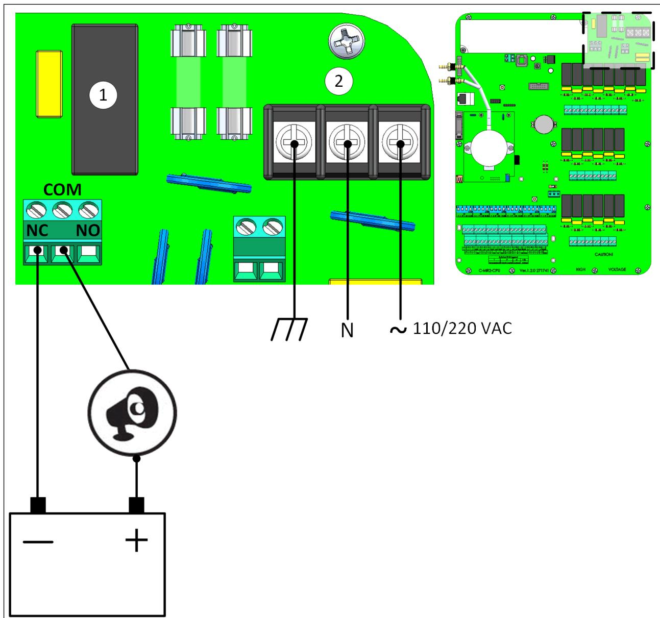
图 13: 警报继电器和电源端口
