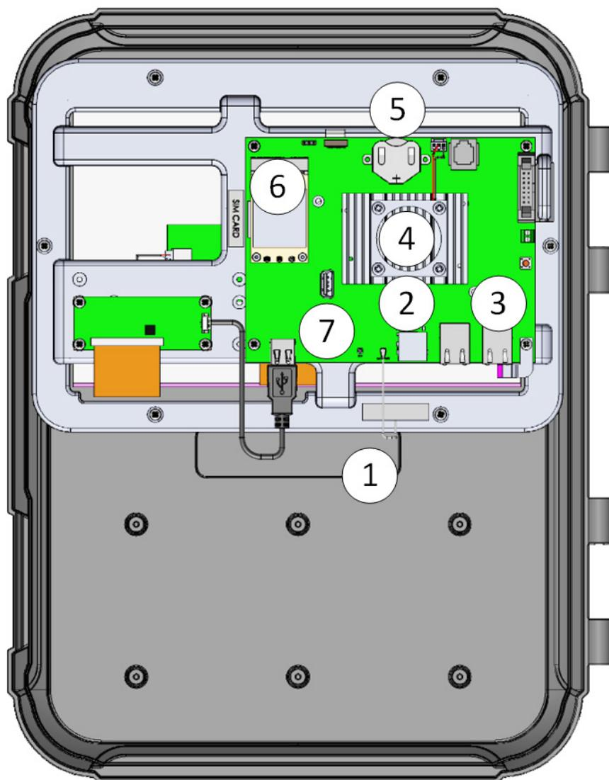
图 8：以太网端口, *Trio* 显示面板版本 1.10
