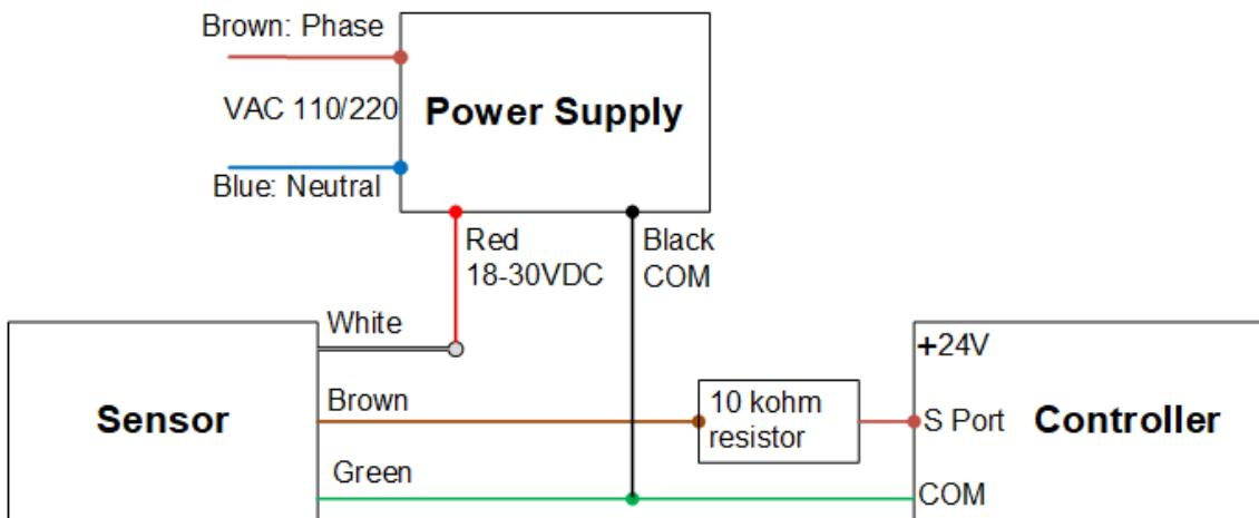
图 33: 氨气传感器接线示意图
