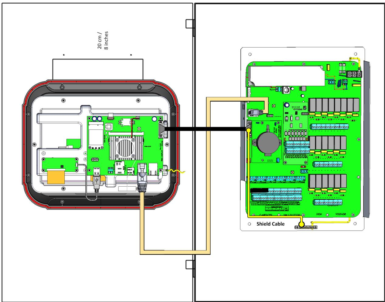
图 59: 面板安装, 机柜打开 (尺寸不按比例)
