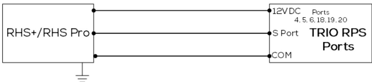
图 29: RHS+/RHS PRO传感器接线图 (转换文本)
