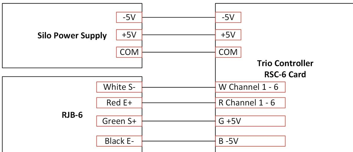
图 42: RSC 卡至筒仓电源/RJB-6 示意图
