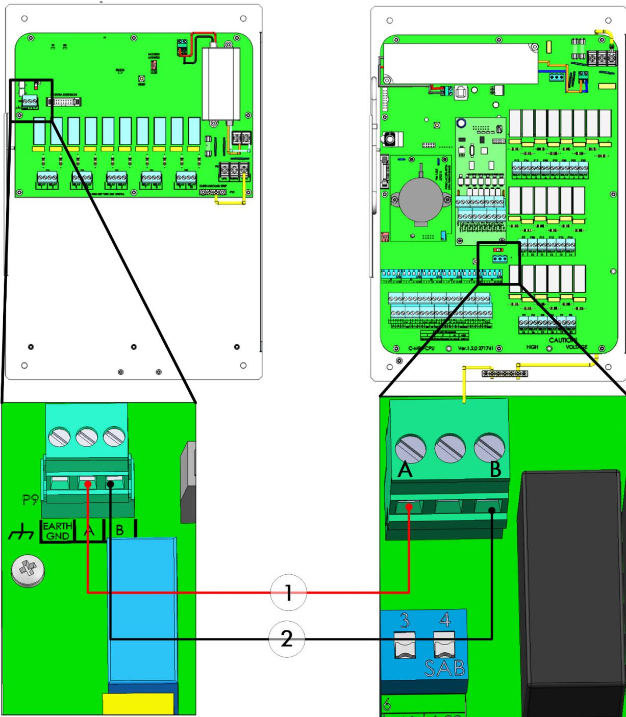
图 65: 面板安装/扩展面板安装接线
