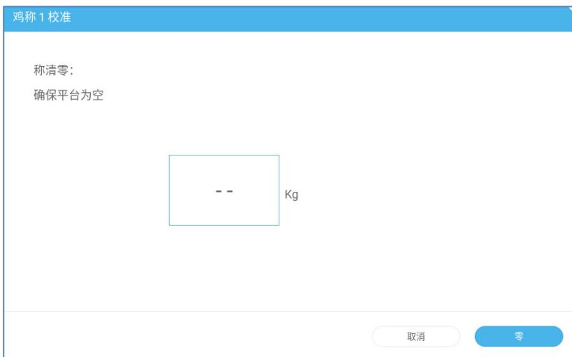
2. 清理称重台面后按下清零键。在接下来出现的界面中输入用于校准的标准重的重量；能够输入的最小重量是 1 公斤。：
