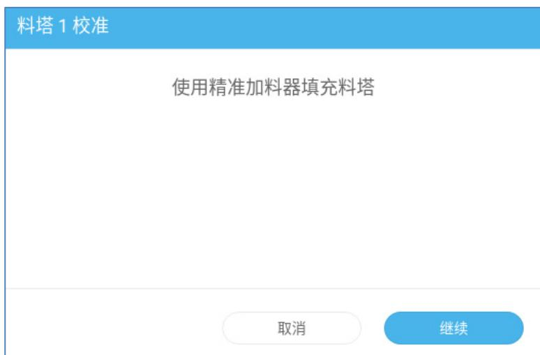
4. 填充已知的料量。在本例中，料塔装了 100kg 的饲料。
