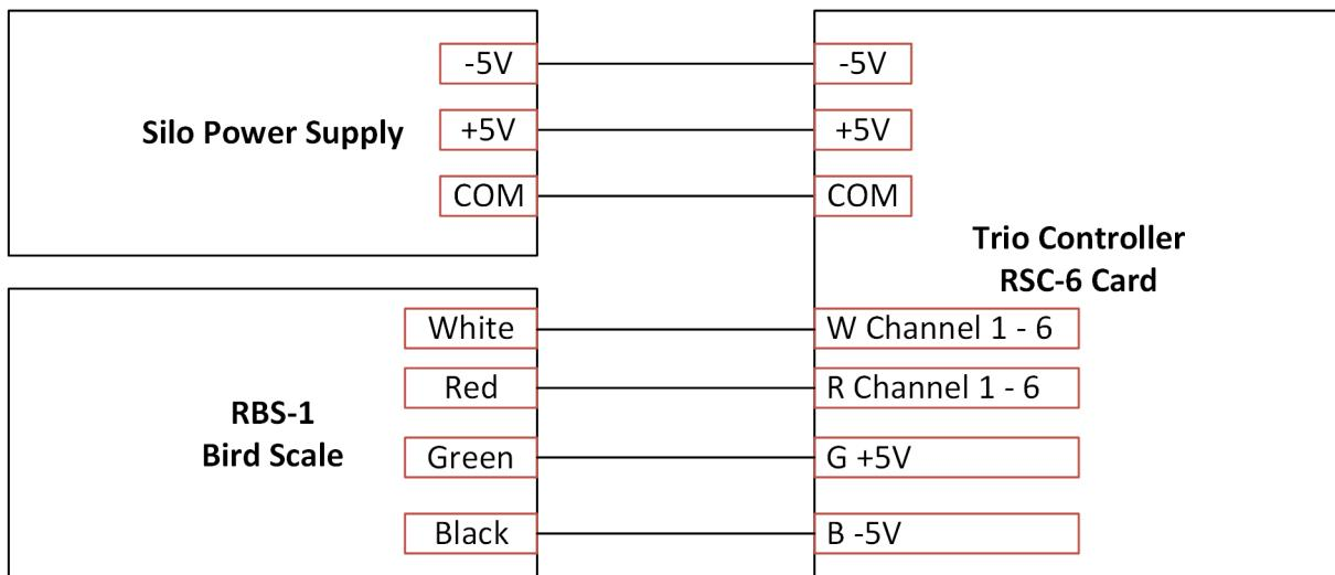
图 40: RSC 卡至筒仓电源/RBS-1 示意图
