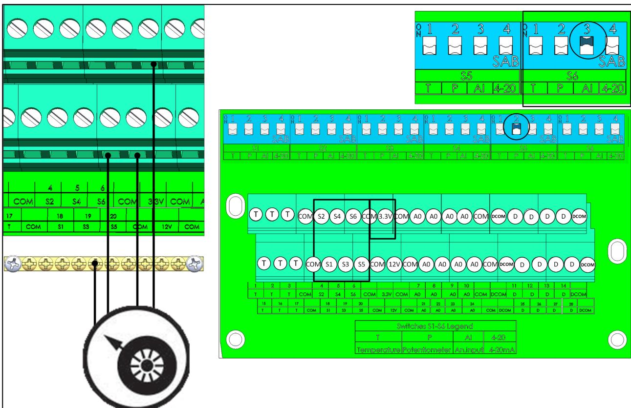
图 30: 电位计接线
