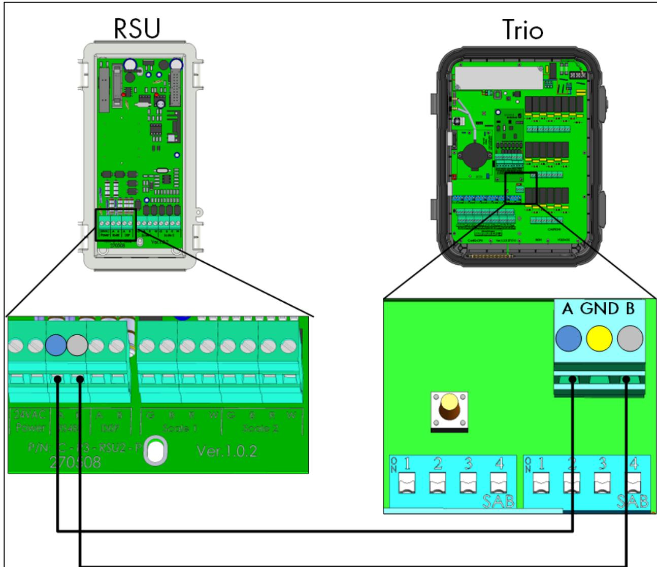
图 43: Trio 和 RSU 的接线图。
