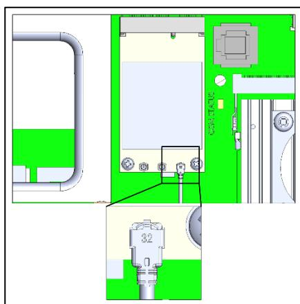
5. 将调制解调器电缆插入连接器，如下图所示。
