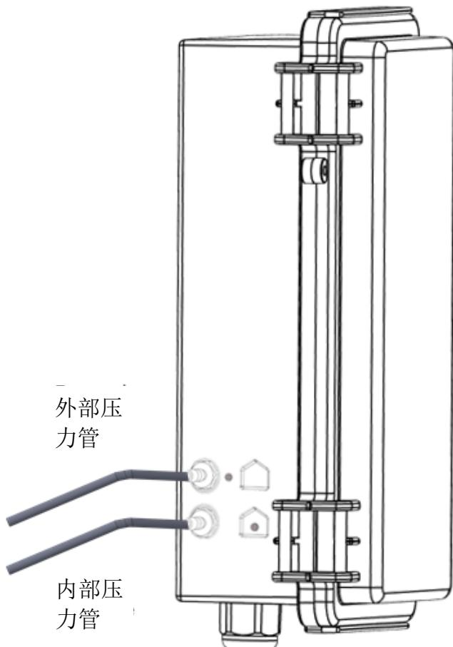
图 38: RPS 压力管
