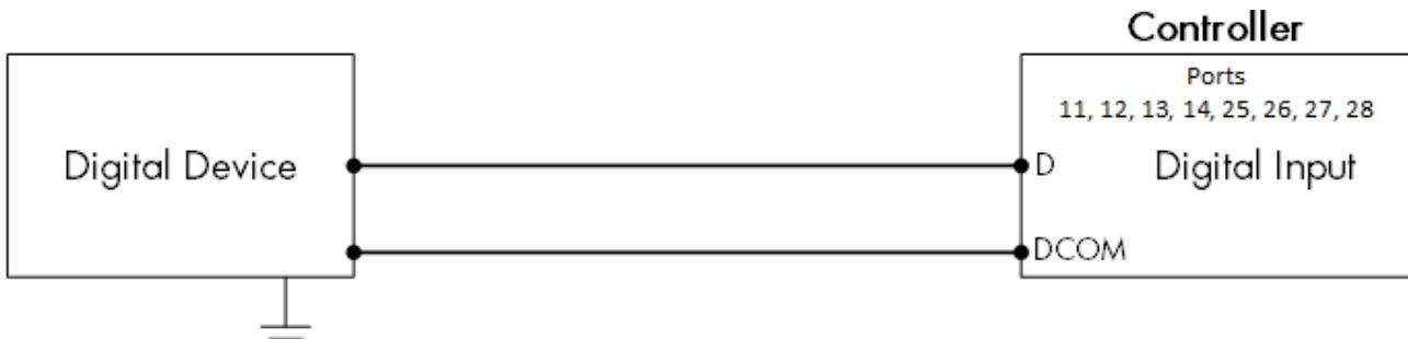
图 20: 数字设备接线图 (转换文本)
