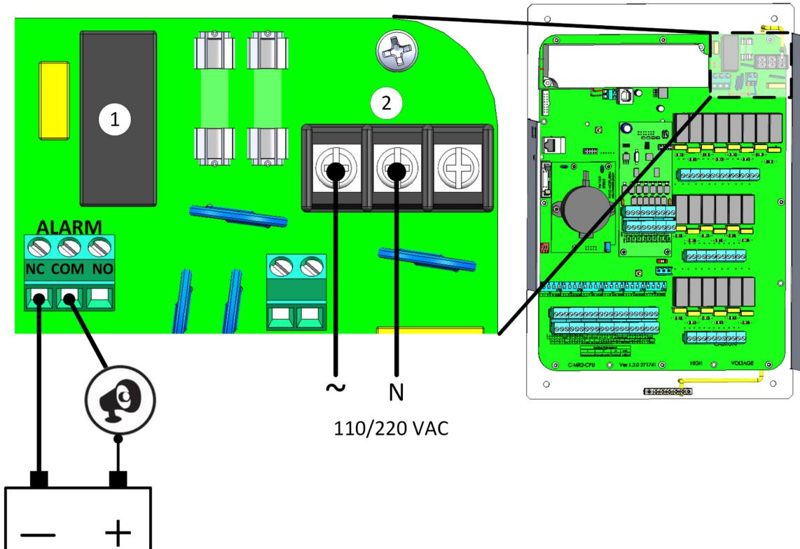
图 60： 报警继电器和电源端口
