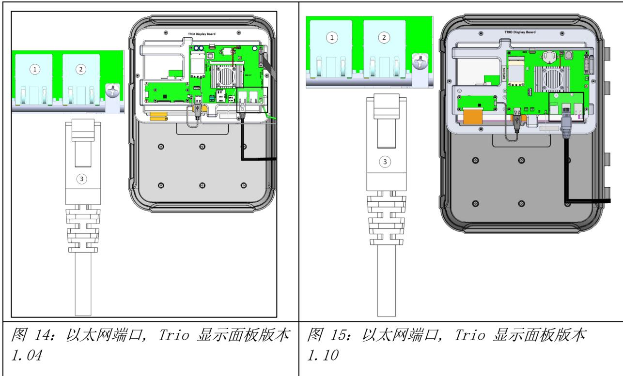
图 14: 以太网端口, *Trio* 显示面板版本 1.04
