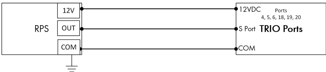
图 37: RPS 接线示意图
