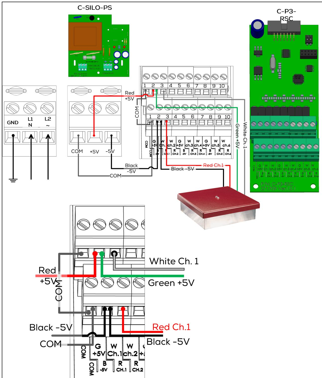
图 39: 称重卡接线到电源和鸡秤
