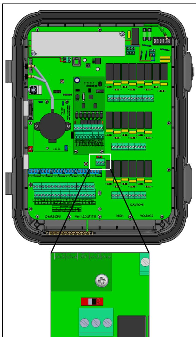
图 45：端接开关
