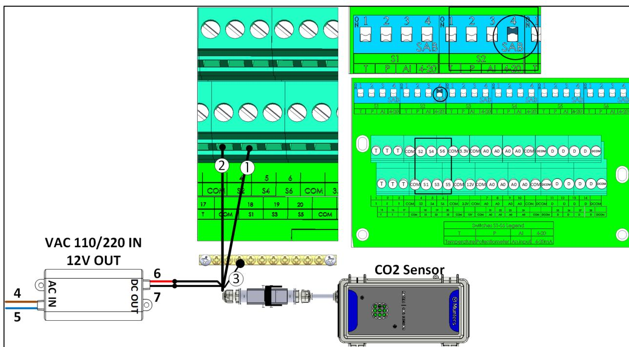
图 21：二氧化碳传感器布线（转换颜色）
