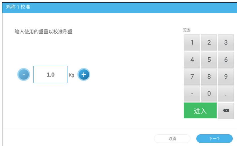
3. 放置一个已知的重量到鸡秤上（示例为 1.0kg），在屏幕中输入该重量，点击继续。
