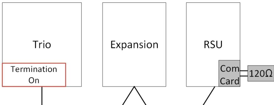
图 44：端接示例拓扑结构
