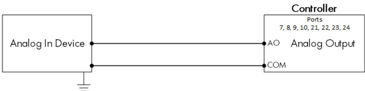
图 18: 模拟设备接线图 (转换文本)
