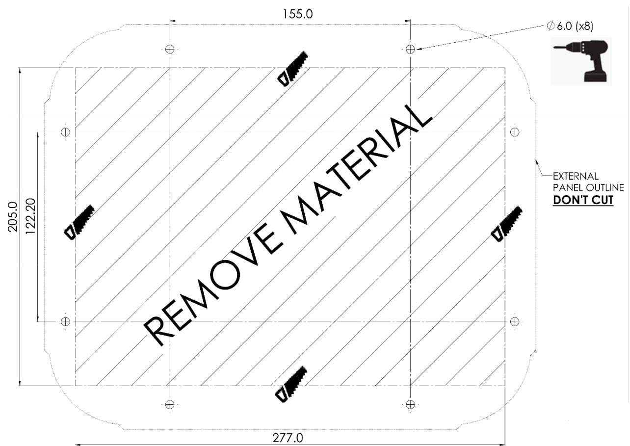
图 58: 面板切割和钻孔尺寸 (毫米)
