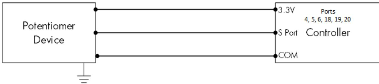
图 31: 电位计接线图
