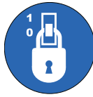
Kuva 5.2 Suojaaminen virran kytkemistä vastaan
