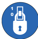
Kuva 2.2 Suojaaminen virran kytkemistä vastaan
