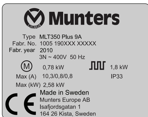
Abb 1.1 Beispiel für Typenschild
