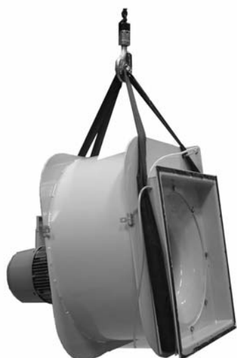
Figuur 3.12 Hijsen van de regeneratieventilator
