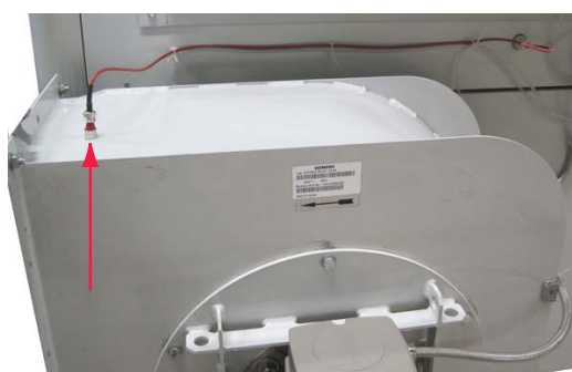
Figur 3.21 PT1000-anlutning på regenereringsfläkt
