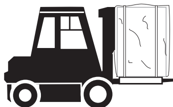
Figur 3.2 Rätt längd på gaffeltruckens armar
