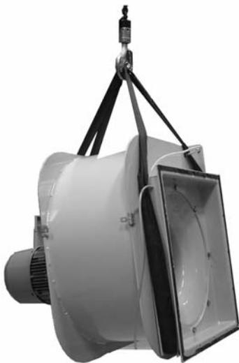
Abb 3.12 Anheben des Regenerationsventilators
