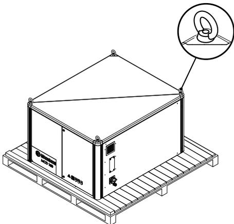
Abb 3.8 Heberingschrauben am oberen Kasten
