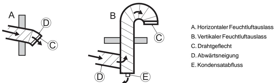
Abb 3.25 Aufbau Feuchtluftauslass
