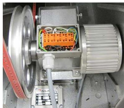
Abb 3.18 Rotorantriebsmotor
