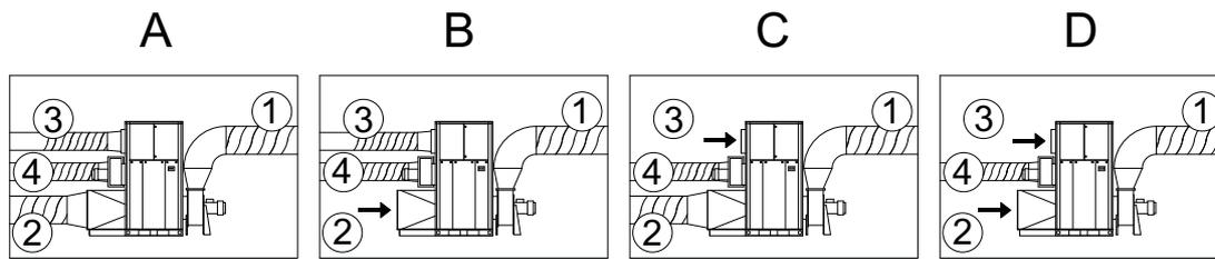
Konfiguration A: Alle Kanäle angeschlossen
