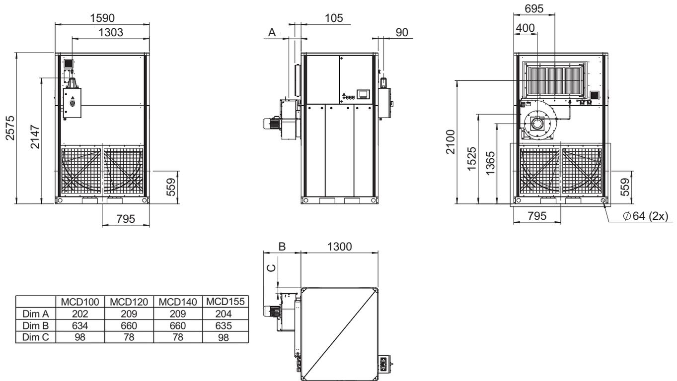
Abb 7.2 Abmessungen der Anlagen ohne Prozessventilator
