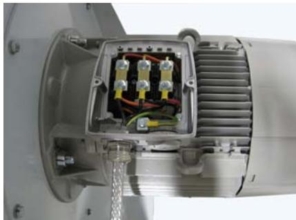
Abb 3.15 Verdrahtung des Ventilatormotors
