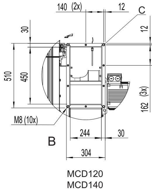
Abb 3.30 Regenerationsluftauslass (Feuchtluftauslass)
