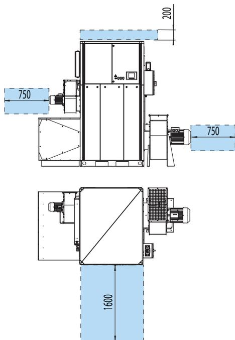
Abb 7.3 Erforderlicher Platz für Wartungsarbeiten
