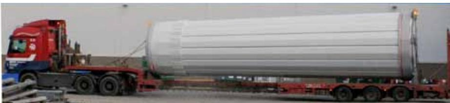
Nach Produktion und Prüfung ist ein Turmabschnitt, bestehend aus 9 Außenhüllen, bereit, um demontiert und verpackt zum Installationsort transportiert zu werden. Auf den Fotos oben und rechts sind die Abschnitte montiert und aufgerichtet als kompletter Windturbinenturm zu sehen.
