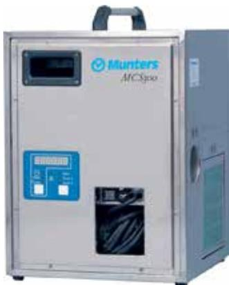
Das Prinzip des Munters Rotors ist einfach, ökologisch und energieeffizient: zwei Luftströme passieren gleichzeitig den sich langsam drehenden Rotor, der mit einem hochwirksamen Trockenmittel ausgerüstet ist. Ein Luftstrom wird entfeuchtet, um die notwendige Trockenluft zu liefern, während der andere, gegenläufige Luftstrom den Rotor trocknet und die angesammelte Feuchtigkeit nach außen abgibt.
