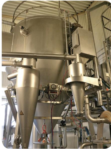
Der Sprühturm, in dem jährlich 13 Tonnen Pollenpulver über die Trockenluft eines Munters-Sorptionsentfeuchters produziert werden.
