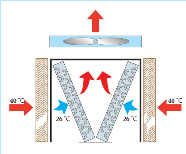
El aire ambiente caliente que pasa a través de la estructura EC Cool entra en contacto con el agua que fluye libremente por la estructura. El agua absorbe la energía térmica, lo que produce la evaporación del agua y enfría el aire.
