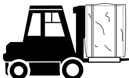
Obrázek 3.1 Správná délka ramen vysokozdvížného vozíku
