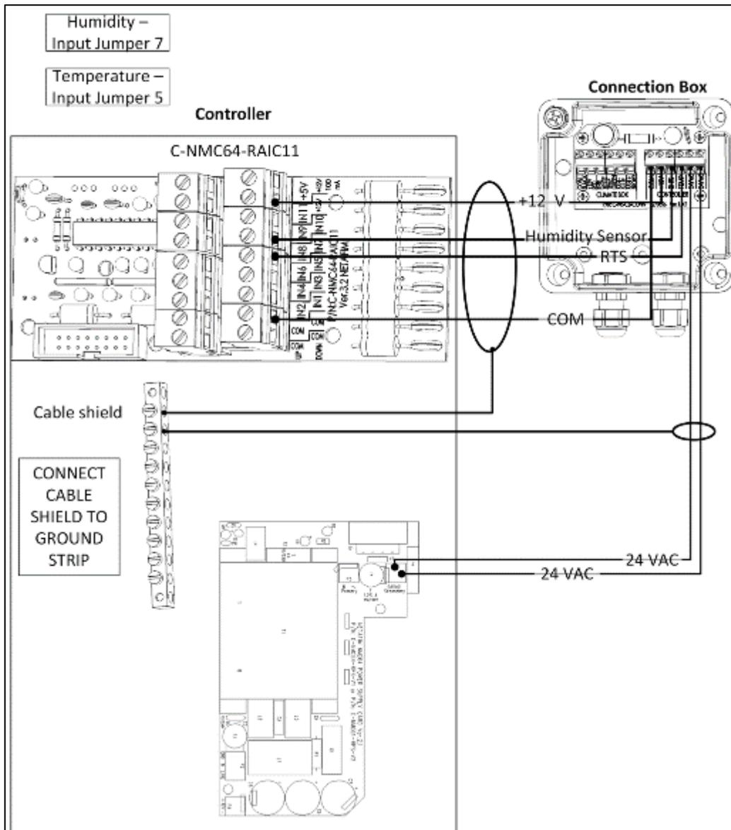
*NOTA* Cablare i terminali 24 VAC del box di misurazione in 24 VAC sui terminali di output.
