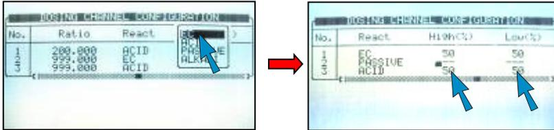
Es: Se il canale dosatori 1 è impostato per per iniettare 10 litri/m<sup>3</sup>, autoregola l'iniezione tra 5 e 15 litri/m<sup>3</sup> per raggiungere il livello EC.
