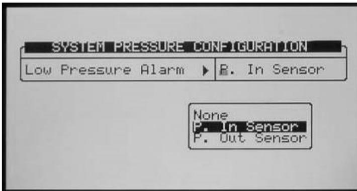
Definisce quale sensore di pressione (ingresso o uscita) debba essere usato per definire la pressione di sistema. Questo sensore potrà essere definito per fermare il sistema in caso di bassa pressione. (vedi tabella 1.7).
