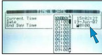
Orario di stop per la misurazione dell'irrigazione e del dosaggio dalle valvole e dai canali dosatori
