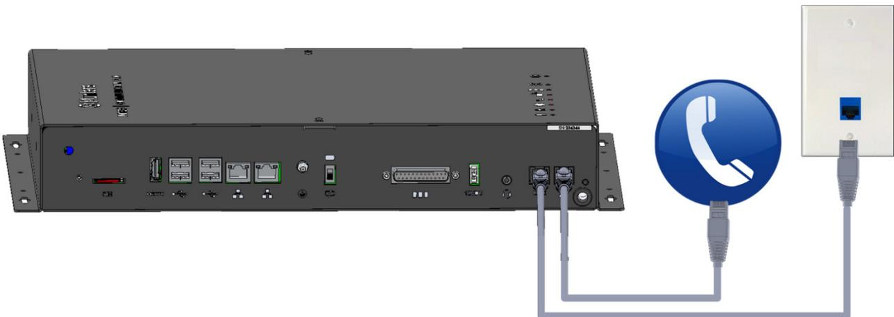
**NOTE** El cableado de conexión de salida del módem de la línea telefónica debe proporcionar un aislamiento doble. Utilice un cableado mínimo de 26 AWG o mayor para la conexión de la línea telefónica.
