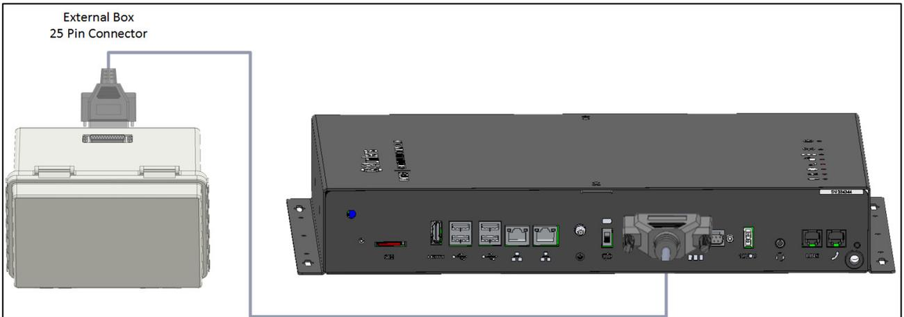
图 4: 外接箱体 - Communicator 2.0电缆
