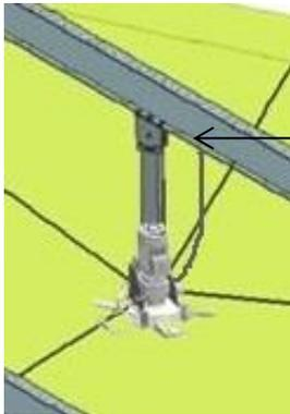
Installez le fil de protection antichute sur le chevron de la même manière que le fil de fixation. Attachez le fil à un écrou à œillet arbitraire sur le dispositif du moteur. Le fil de protection antichute ne doit pas être serré à l'aide d'une passoire, mais serré à une tension qui peut être obtenue manuellement.
